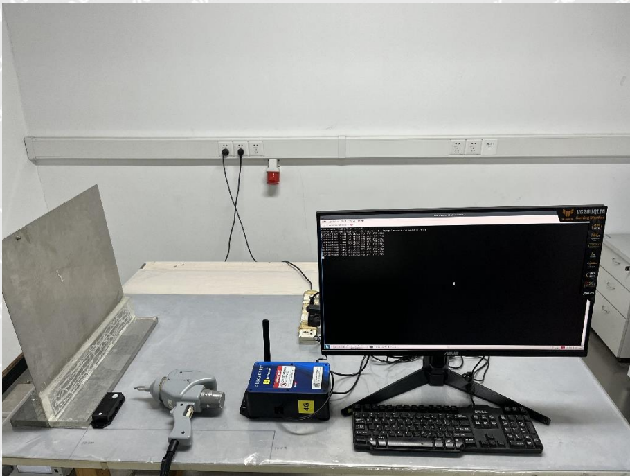
EN 61000-4-2 Test View
